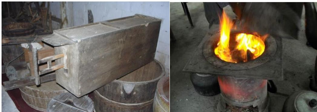
封闭的燃烧环境带来一个问题——氧气的不足使得燃料燃烧效率降低。针对这个问题，一种解决方案是增加鼓风系统。鼓风机鼓入的空气能加快燃烧的速率，
