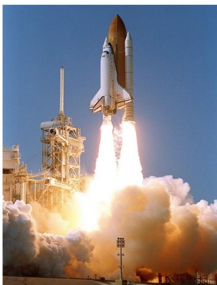
单位质量的固体推进剂燃烧产生的热量很高，并且常温下比较稳定，一旦配制可以较长时间存放。然而，固体推进剂的一大劣势再于一旦点燃很难熄灭，燃烧的快慢也很难控制。这对于需要精密计算的空间技术来说是一项很大的劣势。
