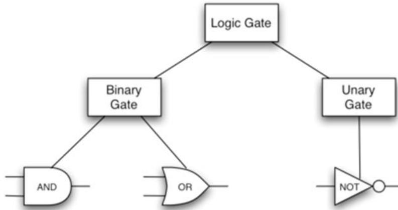
图 1.11 逻辑门的继承阶层架构
