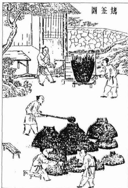
图 7-16 中国古代铸造 《天工开物》(宋应星,公元 1587—1664 年)
